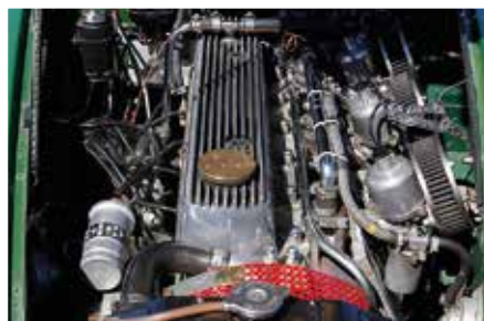
MOTORFAKTA. Den raka sexan matas av tre SU-förgasare, så det gäller att justera dem i rätt harmoni. Då levererar motorn runt 160 hästar - och de har bara knappt 1 000 kg att flytta på.
