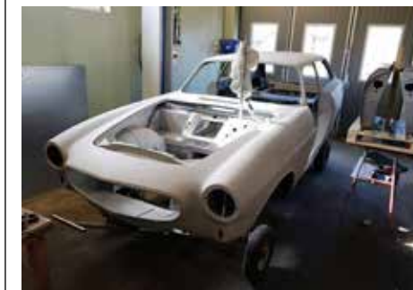
MYCKET ARBETE. Denna Volvo P 1800 har Björn och Roger fått återskapa det mesta på. Bortåt hälften av plåten var bortrostad. Nu är allt lagat och grundat. De kunde konstatera att det varit mycket halvdan handknackning av karossen vid tillverkningen.
