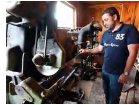
PRECISION. Sågbladen är hårdvaluta eftersom det inte längre tillverkas några sådana. – I den här maskinen vässar jag dem när de blir slöa. Sedan ska varje tand vinklas var för sig så att de sågar rätt, berättar Kim.
