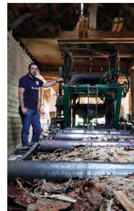
NAVET. Själva hjärtat i sågverket är den här mäktiga pjäsen. – Den står på ett fundament av 100 kubikmeter betong. Det krävs för att hålla den på plats, säger Kim Jansson.
