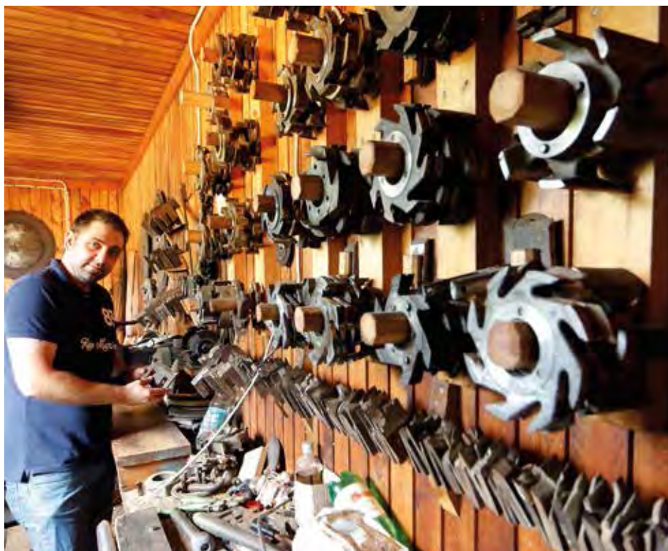
STORT URVAL. En hel vägg med fräsverktyg har Kim att välja på. – Och har jag ändå inte rätt så tillverkar jag nya. Det räcker att jag får en profit av en list att utgå ifrån, berättar han.
