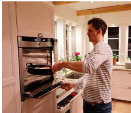
RESTAURANGTÄNK. Ugnen ska vara i arbetshöjd och luckan är av typen "slide and hide" och kan skjutas in helt under ugnen så att den inte är i vägen.
