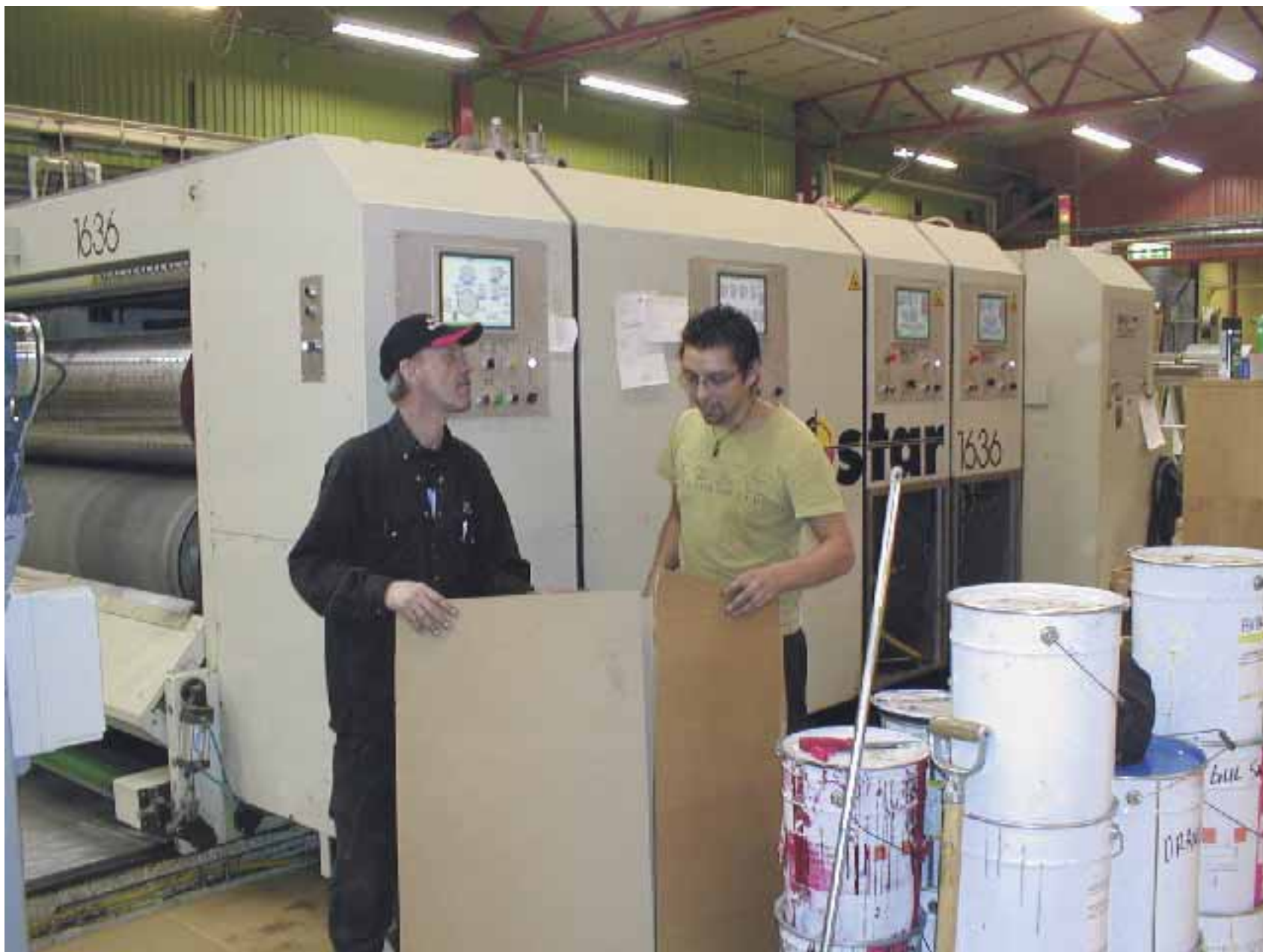
Eurostar tryckpress för två färger och rotationstryck. En av flera stora maskininvesteringar Kilafor's Emballage AB gjort för högeffektiv tillverkning av kundanpassade wellådor.
