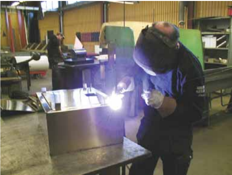
Verktygsskåp i rostfritt till ett Parator-schassi under tillverkning på Häggglunds Plåtslageri i Bollnäs.
