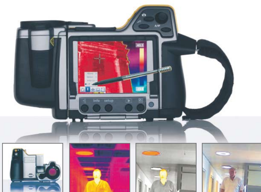
Inspektion av kylt innertak. Värmebild, sammanslagning av värmebild och digitalfoto (Thermal Fusion) och digitalfoto.
